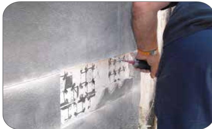
Prove di resistenza al fuoco in facciata su una parete di 3x3 mt isolata con sistema spideREX K8, sottoposta all'azione di un bruciatore da 300 KW per la durata di 10 minuti.
